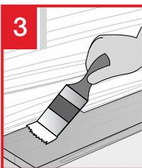
Sơn lớp sơn lót Acrylic SCG dành cho xi măng sợi gỗ 1 lần, để khô hoàn toàn trong 4-6 tiếng. Trường hợp bề mặt sơn không đồng đều, sơn phủ lại và để khô hoàn toàn trước khi sơn lớp sơn cuối.
