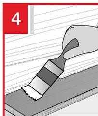
Sơn màu sơn theo yêu cầu của loại sơn Acrylic SCG dành cho xi măng sợi gỗ khoảng 2-3 lớp cho đến khi đạt được cường độ về màu sắc thích hợp. Sơn mỗi lớp sơn một cách nhẹ nhàng để chúng khô hoàn toàn, và cần sơn theo cùng 1 hướng theo vân của tấm ván. Nên dùng loại chổi sơn mềm để có được bề mặt sơn mịn, trong khi đó dùng chổi sơn cứng sẽ làm sàn gỗ trầy và mảnh gỗ vỡ ra.
